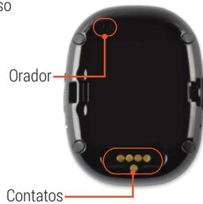
Antes de utilizar o FINDER pela primeira vez, deve cobrá-lo. Ligar o cabo de carregamento fornecido com o ímã aos contactos do FINDER. Em seguida, ligar a porta USB a um adaptador de tomada e ligá-lo a uma tomada de alimentação. Uma vez ligado à fonte de energia, o FINDER ligar-se-á automaticamente. **Por favor, carregue o FINDER até o LED vermelho acender continuamente.**
