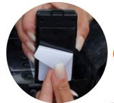
Montar o FINDER no compartimento do motor utilizando a fita adesiva
