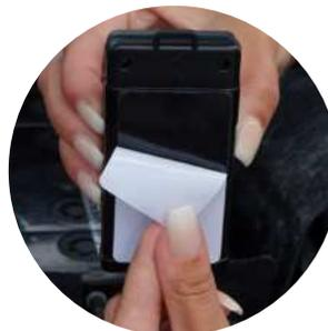
1. Montar o FINDER no compartimento do motor utilizando a fita adesiva
